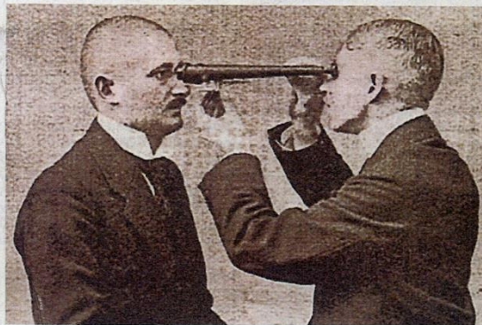
Augenabstandsmessgerät, Firma Busch um 1920. FOTOS: OPTIKINDUSTRIEMUSEUM
