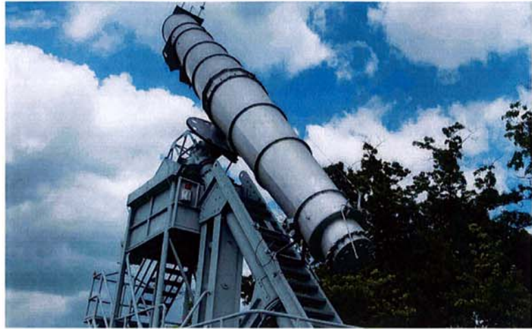
Rathenower Brachymedial-Fernrohr, weltgrößtes astronomisches Fernrohr dieser Bauart, das eine Kombination von Refraktorteleskop und Spiegelteleskop darstellt und die Vorzüge beider Grundtypen in sich vereint.
